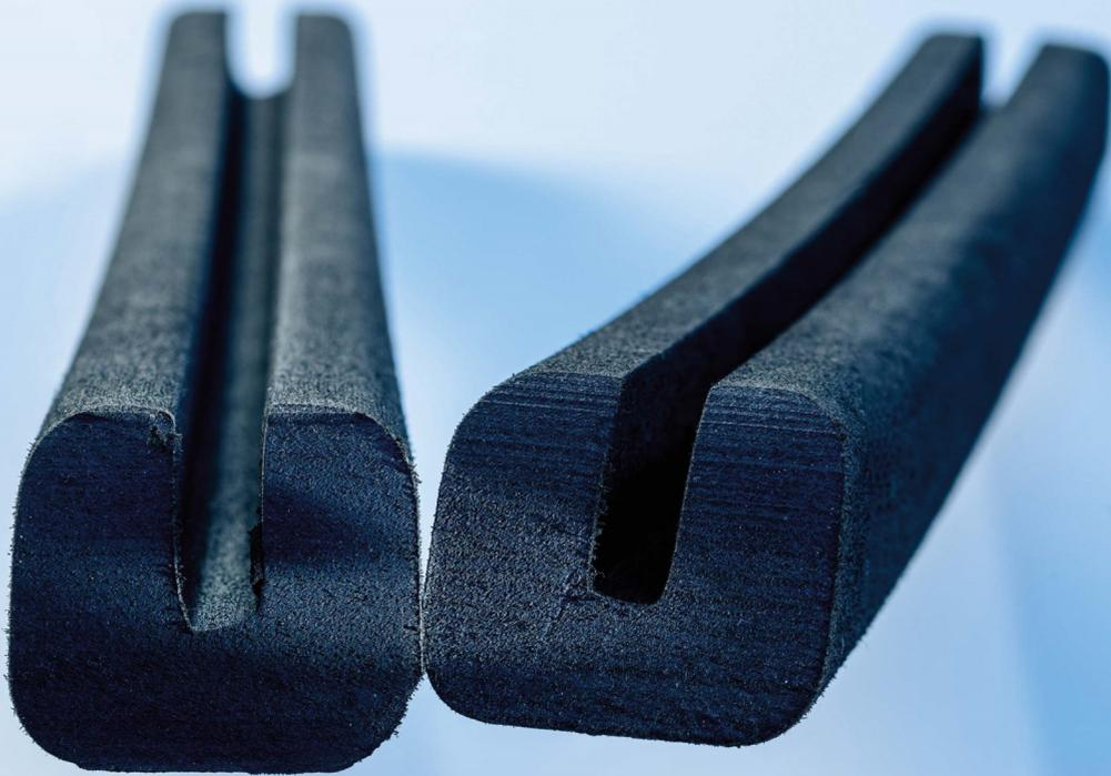
Bei manuell gefertigten Dichtungsprofilen handelt es sich um Meterware, die nicht extrudiert wird. Das Material wird in der Regel geschnitten oder gefräst. Entsprechende Längen werden entweder durch Verklebung oder (bei thermoplastischen Materialien) durch Verschweißung erreicht.
